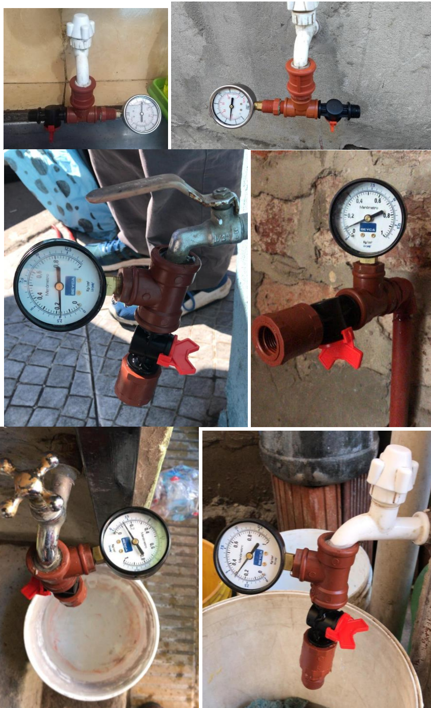
Imágenes de la campaña de medición de presión en canillas conectadas directamente a las redes públicas de agua del barrio
