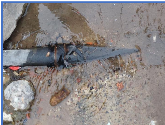
Figura 3.- Manguera de agua pinchada sobre terreno utilizada para abastecer a 100 familias en Santo Domingo y la calle s/n (La Loma-Villa 21-24)
