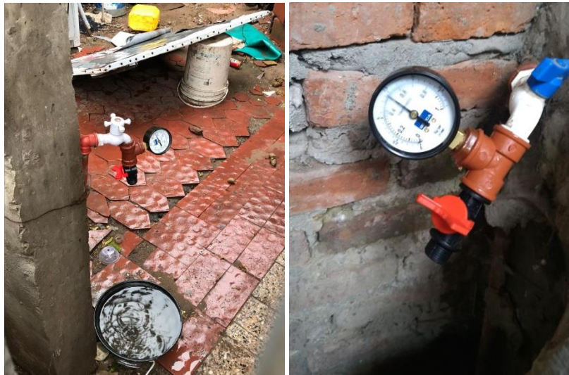
Imágenes de la campaña de medición de presión en canillas conectadas a las redes públicas de agua del barrio
